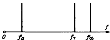
Рис. 1-12. Взаимное расположение граничных частот транзистора.
